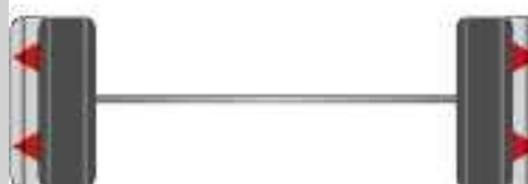
Spurverbreiterungen von 10-90 mm möglich Track increase available from 10-90 mm
