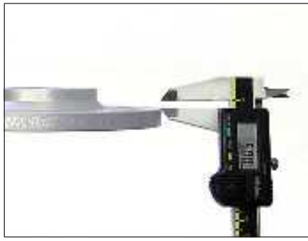
Darstellung Aussenfase 5x45°/ Outer bevel 5x45°
